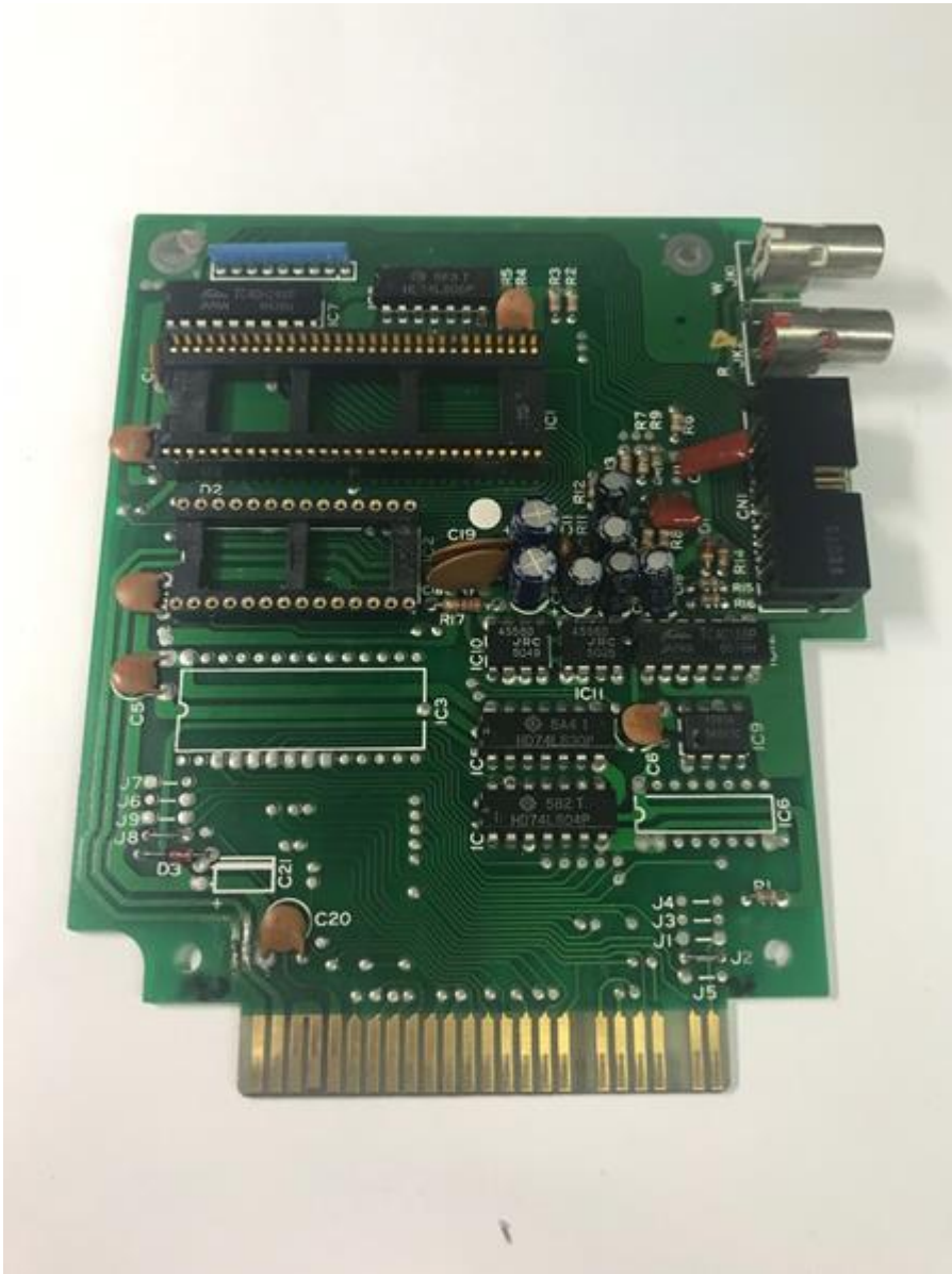
Toshiba HX-MU900 printplaat voorbereid voor de installatie van de uitbreidingsprint.
